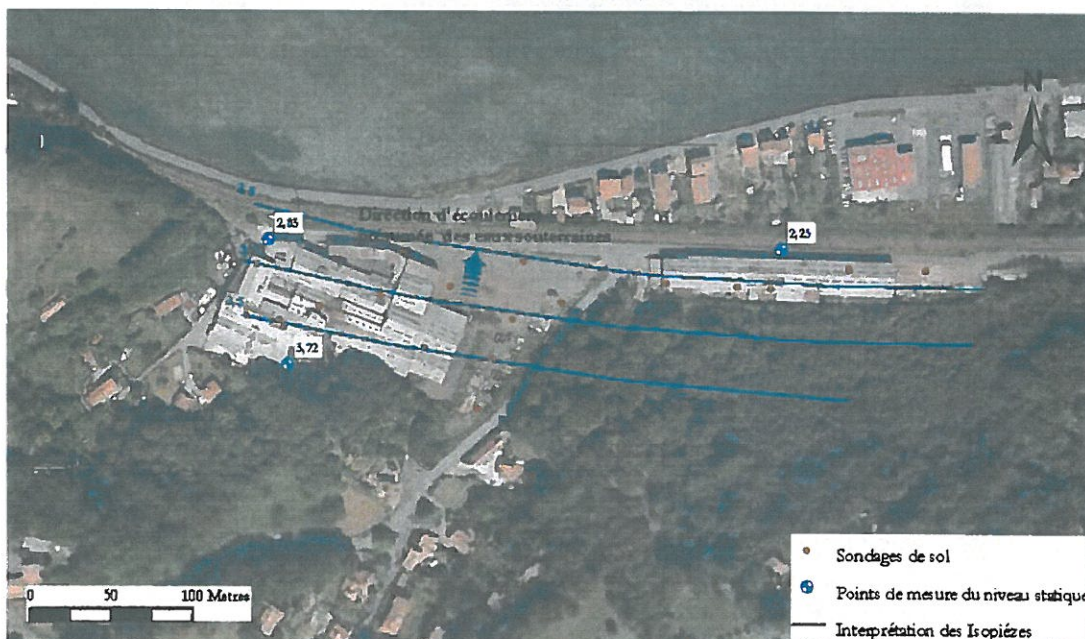
Figure n°16 : Nivellement des piézomètres et niveau statique (TEC.08.132.TER.AF(RA.001.1),014,1)
